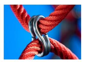
Las abrazaderas Corocord 'S' se utilizan como conexiones universales en los productos Corocord. Las varillas de acero inoxidable de 8 mm con bordes redondeados se presionan alrededor de las cuerdas con una prensa hidráulica especial, lo que las convierte en el conector idel: seguro, duradero y a prueba de vandalismo, todo mientras permite el movimiento típico de las estructuras de juego
