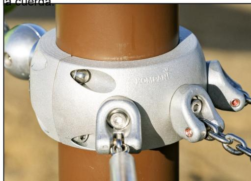
Las abrazaderas inteligentes Corocord están cuidadosamente diseñadas en cada detalle para garantizar una flexibilidad superior en material de aluminio de alta calidad. Las abrazaderas inteligentes se fijan alrededor de los postes con cuatro pernos de acero. Los puntos de fijación no utilizados se cierran con tapones de PA.
