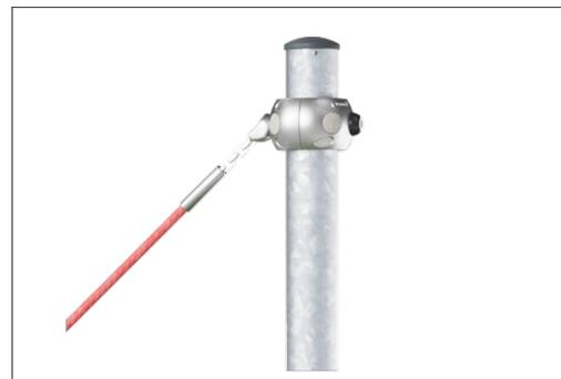
Las abrazaderas inteligentes Corocord están cuidadosamente diseñadas en cada detalle para garantizar una flexibilidad superior en material de aluminio de alta calidad. Las abrazaderas inteligentes se fijan alrededor de los postes con cuatro pernos de acero. Los puntos de fijación no utilizados se cierran con tapones de PA.
