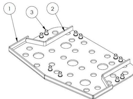
Se debe moldear una placa de acero al carbono galvanizado en caliente de 5 mm dentro del SBR para ofrecer una estabilidad óptima y optimizar el montaje del escalón en el marco.
