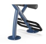
Todos los componentes de acero están hechos de acero al carbono, con una superficie galvanizada en caliente según ISO1461 y una clase de corrosión C3 de pintura en polvo según ISO12944-2. El contenido de plomo para las superficies es inferior a 90 ppm y inferior a 100 ppm para el material base.
