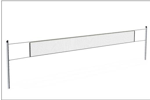
La red está asegurada con abrazaderas de cuerda (DIN741) en la parte superior utilizando un cable de acero de 3 mm, cubierto con un tubo verde de 1 mm. Los extremos del cable se cierran con un talorit de aluminio, creando un lazo de fijación con un diámetro de 10 mm.
