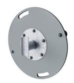
La caja de rodamientos está hecha de acero galvanizado en caliente. El eje del rodamiento está hecho de acero inoxidable AISI304. El rodamiento en sí está hecho de polioximetileno (POM), un termoplástico de ingeniería con alta rigidez, baja fricción y excelente estabilidad dimensional.
