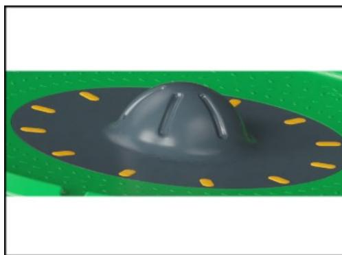
La parte central con el cuenco está fabricada con polietileno de baja densidad recicitable y se fija al anillo exterior mediante 12 puntos de fijación sellados con tapones de nylon PA amarillo.
