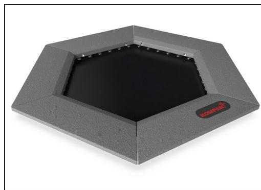
Las losetas están moldeadas en caucho reciclado granulado gris (SBR / NR), y el logotipo de KOMPAN está hecho de monómero de etileno propileno dieno EPDM. Dentro de cada una de las losetas de caucho hay una placa de acero galvanizado en caliente de 3 mm.
