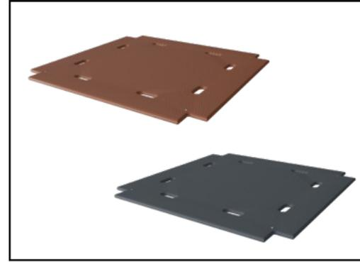
Las actividades de suelo y paneles están disponibles en dos tipos de material: cubiertas de madera contrachapada a prueba de agua de 21,5 mm de grosor de pino y madera de aliso con película antideslizante en ambos lados. Laminado de alta presión HPL espesor 17.8 mm con textura de superficie antideslizante según EN 438-6.
