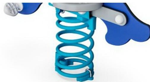
Los muelles KOMPAN están hechos de acero de resorte de alta calidad según EN10270. Los muelles se limpian mediante fosfatación antes de pintarlos con una imprimación epoxi y un recubrimiento de poliéster en polvo como acabado superior. Los muelles se fijan mediante accesorios anti-pellizcos únicos para máxima seguridad y larga vida útil.
