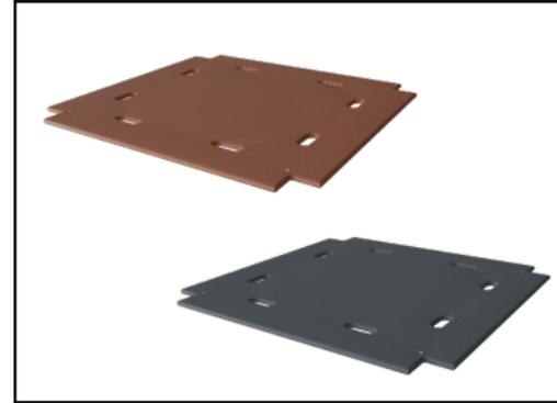
Las actividades de suelo y paneles están disponibles en dos tipos de material: cubiertas de madera contrachapada a prueba de agua de 21,5 mm de grosor de pino y madera de aliso con película antideslizante en ambos lados. Laminado de alta presión HPL espesor 17.8 mm con textura de superficie antideslizante según EN 438-6.
