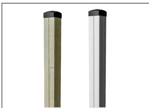
Los postes de torre principales están disponibles en dos tipos de materiales: postes de madera de pino europeo, impregnado a presión Clase 3 con Tanalith E3475 según EN335 (equivalente a NTR Clase AB). Poste de aluminio t=2mm con tratamiento superficial anodizado. Material base EN AW-6060 T66.
