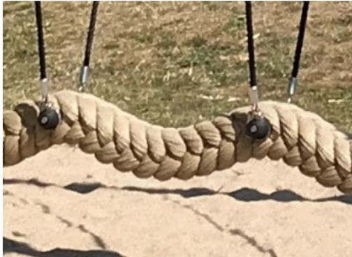
La cuerda del columpio péndulo está hecha de cuerda de polipropileno (PP) en estilo Coconut con una forma cuadrada de 14x14cm. Los extremos de la cuerda de coco están cerrados por unas abrazaderas de acero y sellados por un tubo encogible encolado. Los últimos 10 cm de los extremos de la cuerda se cortan para hacer una borla con función de parachoques para cumplir con los requisitos de seguridad globales.
