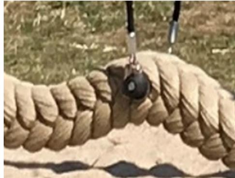
La cadena / cuerdas están unidas a la cuerda de coco por bujes giratorios KOMPAN de acero inoxidable con cojinetes de bronce. Los giratorios tienen una cubierta exterior de PUR negro. El uso de giratorios montados lateralmente proporciona un movimiento sin fricción, elimina los atrapamientos de dedos y pies y aumenta la superficie de pie en la parte superior de la cuerda.
