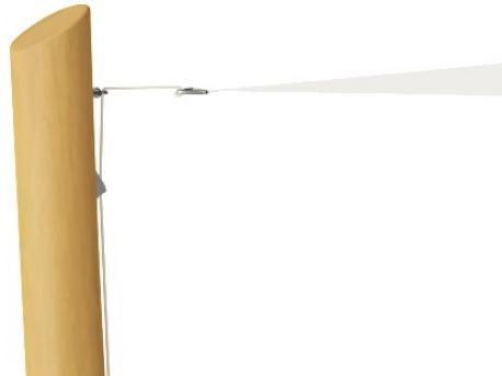
La cuerda se sujeta al poste de Robinia mediante un tornillo de ojo de acero inoxidable y se tensa con un soporte de nailon con carril de cuña. El sistema garantiza que la vela sea fácil de montar, tensar y desmontar continuamente.
