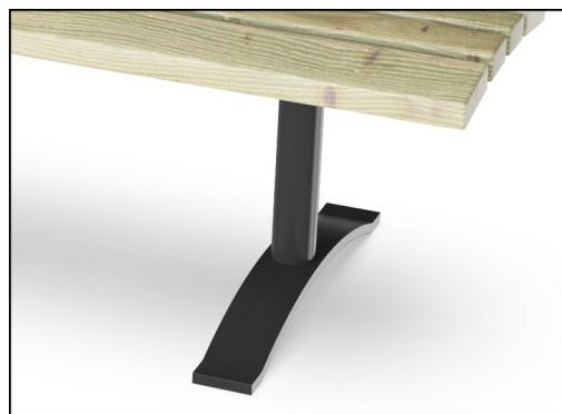
El acabado superior con recubrimiento en polvo en la parte superior de la galvanización se procesa en dos pasos: molienda ligera y barrido limpio, recubrimiento en polvo - espesor 70-120  $\mu\text{m}$ .
