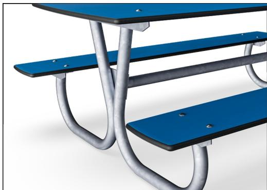
Todos los tableros son de laminado de alta presión HPL con un grosor de 17,8 mm según la norma EN 438-6 y tienen una textura superficial antideslizante. La estructura multicapa hace que los tableros sean duraderos y aptos para su uso en exteriores, con una gran estabilidad frente a los rayos UV y una alta resistencia a los impactos, los arañazos, el fuego, el agua y la humedad.
