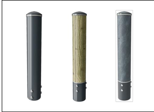
Los postes principales con zapata de acero galvanizado en caliente están disponibles en diferentes materiales: postes de madera de pino impregnados a presión. Pregalvanizado interior y exterior con postes de acero con acabado superior con recubrimiento en polvo. Aluminio sin plomo con acabado superior anodizado en color.
