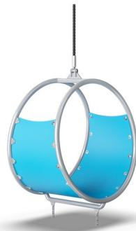
La cápsula está diseñada con una estructura soldada de dos anillos de acero galvanizado en caliente y recubiertos de polvo. La membrana consiste en un material engomado a prueba de fricción de calidad de cinta transportadora con una excelente resistencia a los rayos UV.
