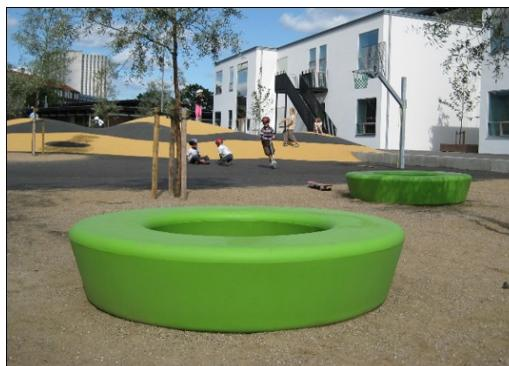
Los Loops pueden anclarse al suelo rellenándolos con agua o arena mediante tapones integrados. Alternativamente, pueden fijarse utilizando soportes de superficie o de suelo.
